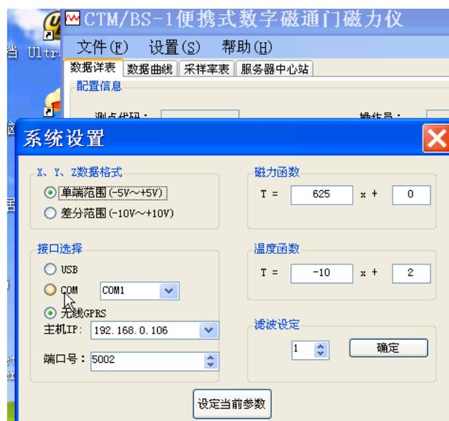
在系统设置里选择无线 GPRS，主机 IP 使用默认值，端口号也使用默认值 5002。点击设定当前参数后会在下面的状态栏提示：
